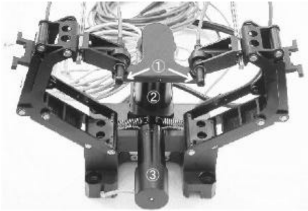
図9 試作した姿勢保持リンク機構： カメラ、 yaw 軸モータ、 roll 軸モータ
