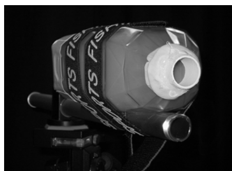
図 2: ペットボトルを利用した空気砲。
