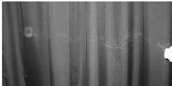
図 4: 空気砲から空気の塊が発射された様子。 ドーナツ状の渦を構成する。
